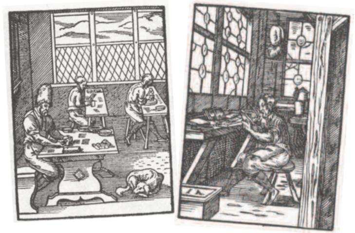
feu avant d'être fendue et aplatie avec le pressage, toujours à chaud, puis le tracé sur la plaque ainsi obtenue à l'aide d'un gabarit et d'une pointe sèche, la découpe, le rabotage, la mise en forme, la taille des dents, le surfacage, le façonnage des dents, le meulage, le ponçage et, enfin, le polissage à la meule garnie de lanières de peau de chamois. Les déchets obtenus pendant ces opérations successives sont finement broyés pour entrer dans la composition d'engrais.
