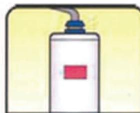
Tuyau de ventilation du chauffe-eau est corrodé ou n'est pas raccordé au chauffe-eau
